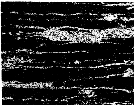
共晶碳化物不均匀度评级图 (4级) (>40~63 mm)
